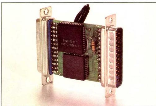
*Das "Innleben" von SAM. Zwei CMOS-Custom-Chips ermöglichen einen individuellen Soft- und Hardware-Schutz, der es den Crackern fast unmöglich macht, die Software zu crachen.*
