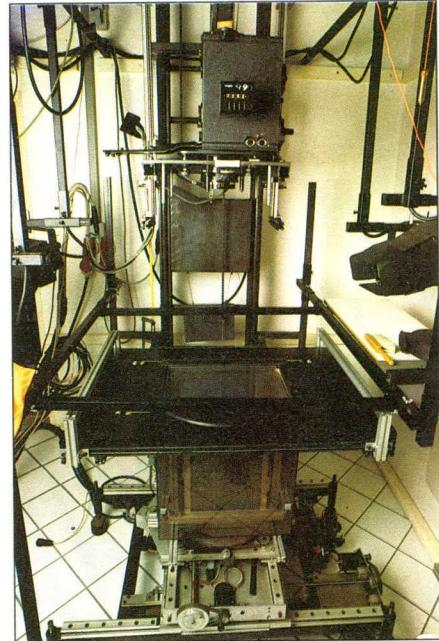
Trickisch mit eingebautem Monitor für "schnelle" Produktionen
