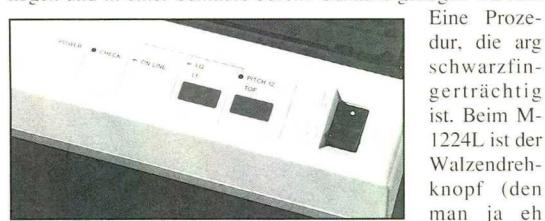
zen soll) durch ein Rändelrad abgelöst worden, das sich - wie der Netzschalter - an der Oberseite des Gehäuses befindet. Lob für diese platzsparenden Details.
