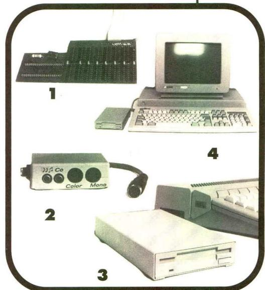
**1 Speichererweiterungen:** steck- oder lötbare Speicherplatine, auch für Mega ST, jede Erweiterung einzeln im Computer getestet.
